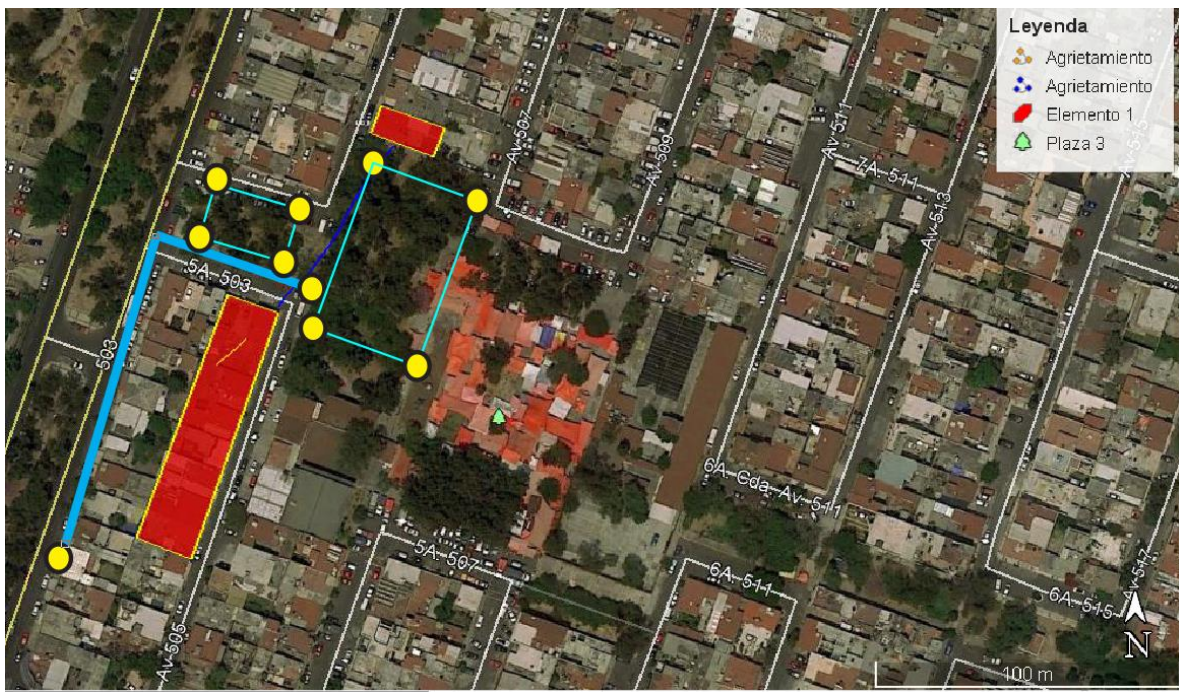
Figura 4. Propuesta de TRE-3D en la zona de estudio (490-520 m lineales de longitud aproximadamente).
